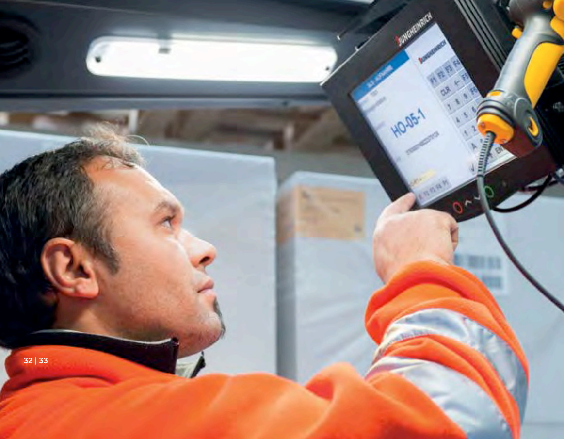
Optimierter Materialfluss: Ein Mitarbeiter von Streng Plastic steuert das Jungheinrich Warehouse Management System über einen Bildschirm am Stapler.
