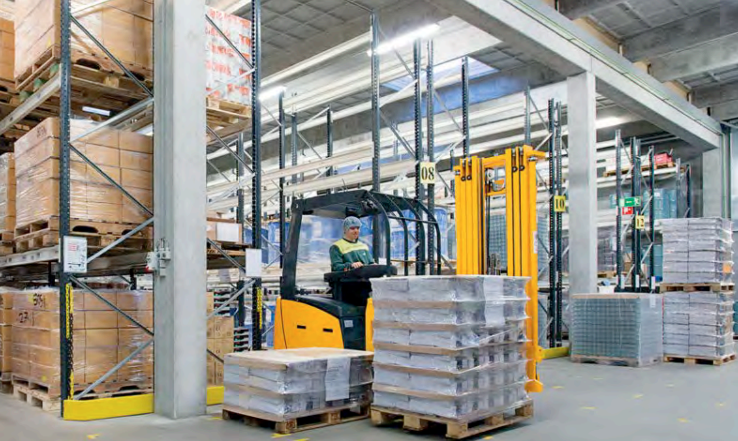
Flexibler Schmalgangstapler: Der Elektro-Frontsitz-/Dreiseitenstapler EFX 410–413 kann geführt im Schmalgang oder frei verfahrbar im Breitgang eingesetzt werden und bei Bedarf sogar Lkw entladen.
